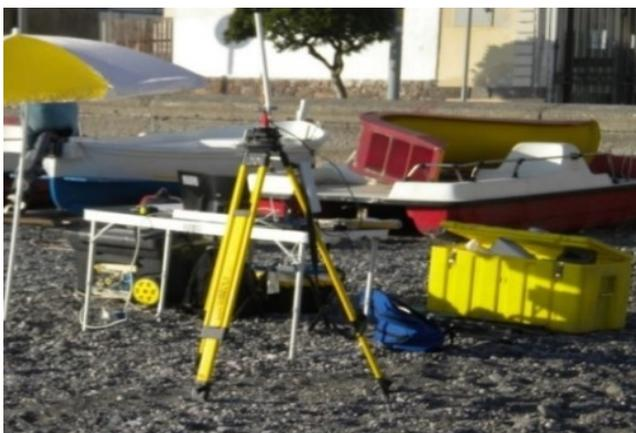
Figura 9 Control Ground Station e creazione del piano di navigazione da usare per i rilievi
