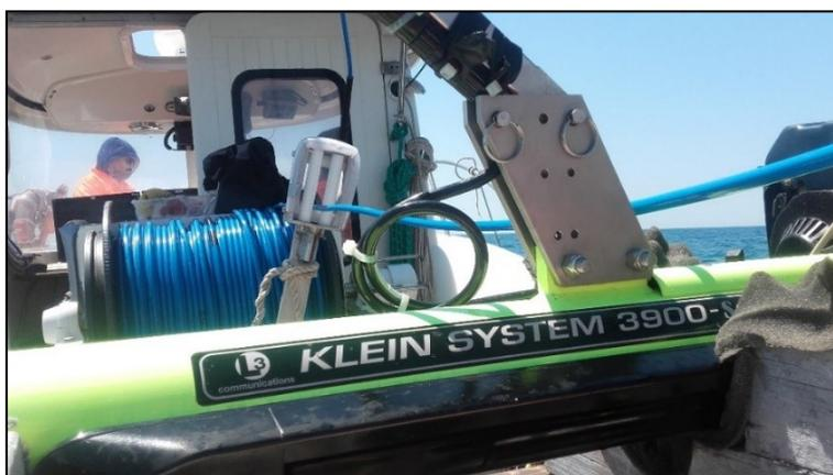
Figura 18 Sistema SSS Klein 3900 dotato di verricello elettrico
