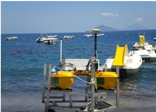
Figura 8 Tipologia di Sistema ASV in fase di mobilitazione e in fase operativa
