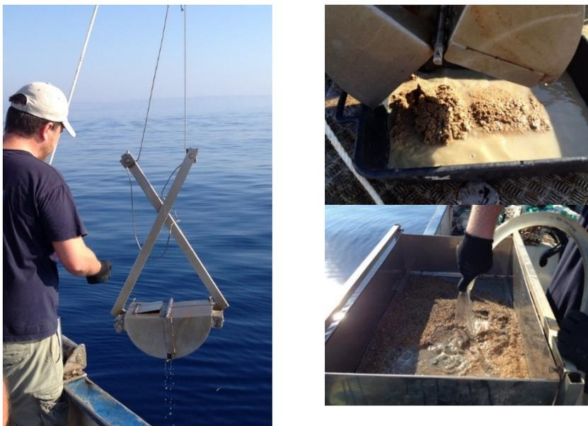
Figura 20 Recupero della benna Van Veen e setacciatura sedimenti su maglie di 1 mm
