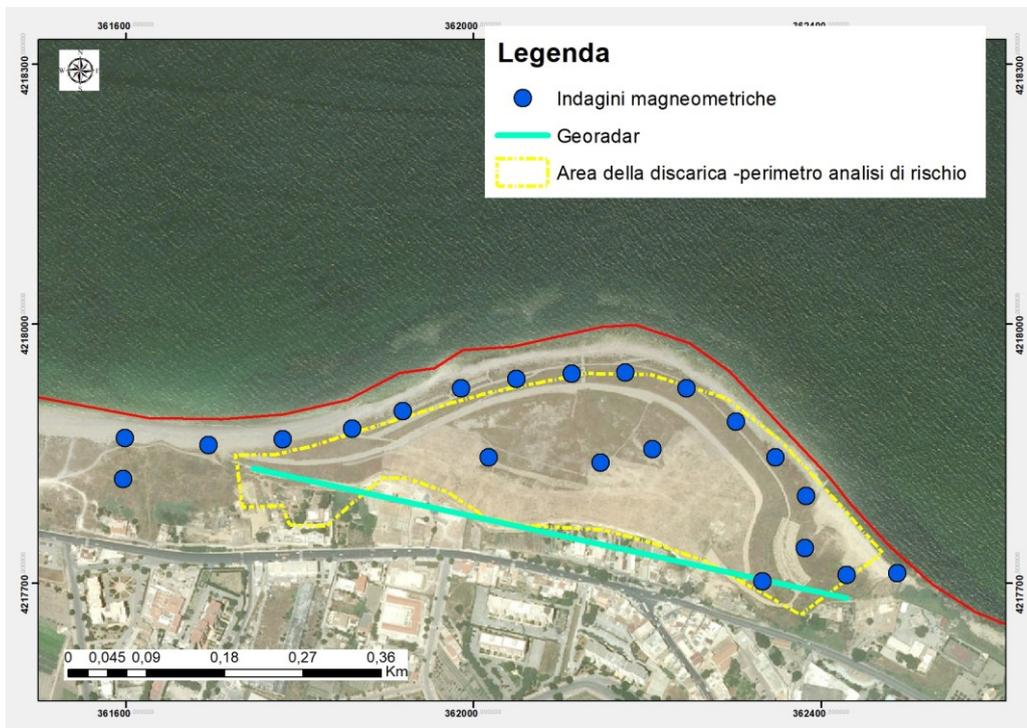
Figura 12 . Disposizione indagini magnetometrica e georadar
