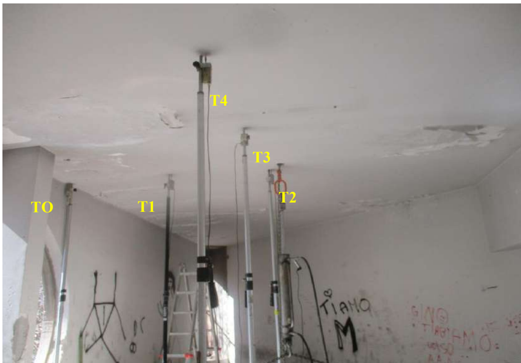
Trasduttori per il rilievo degli abbassamenti montati su aste
