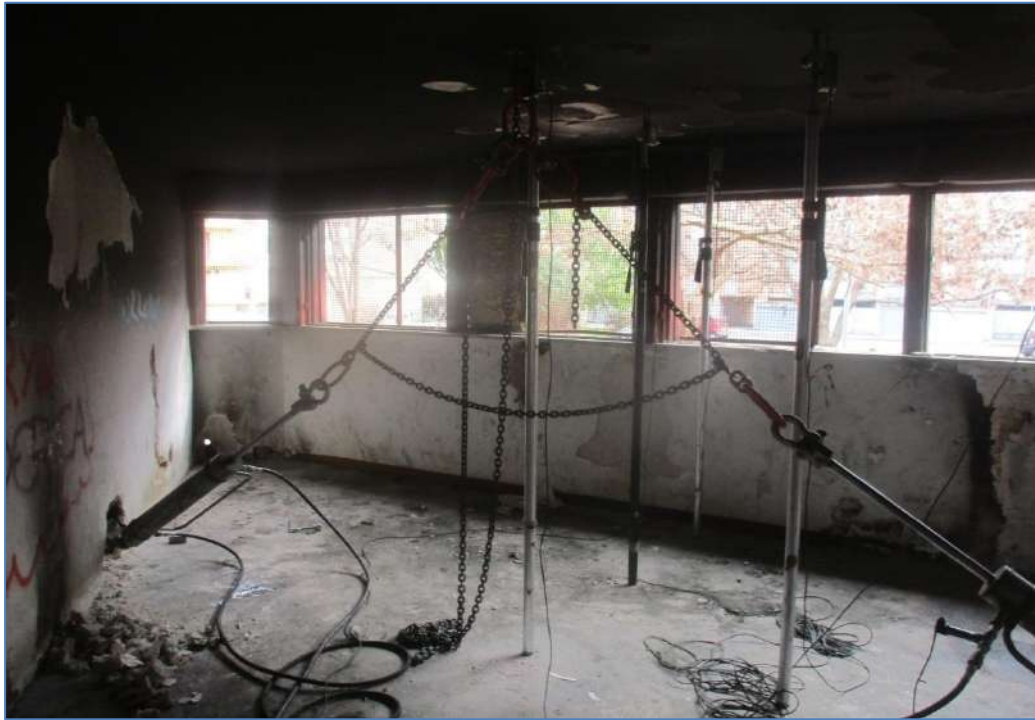
Martinetto oleodinamico utilizzato per l'applicazione del carico.
