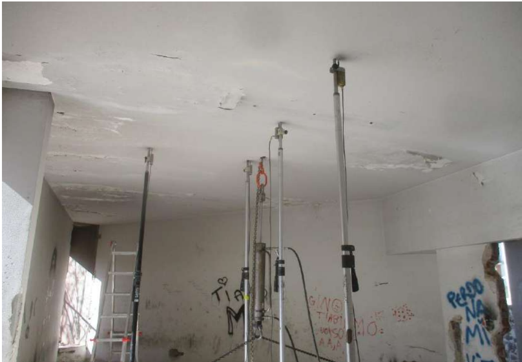
Martinetto oleodinamico utilizzato per l'applicazione del carico.
