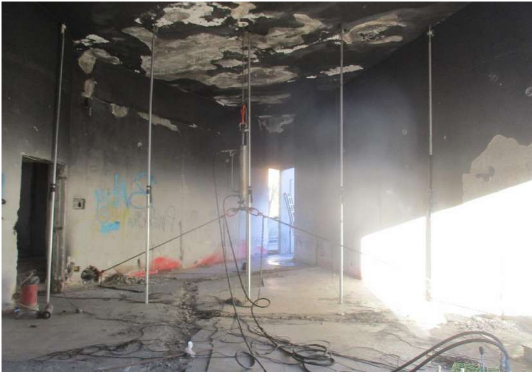
Martinetto oleodinamico utilizzato per l'applicazione del carico.
