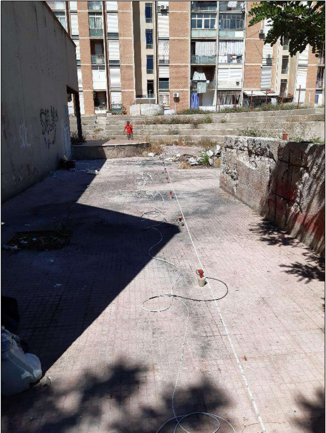
Battuta con offset 3 m dal geofono 1 lungo la stesa sismica
