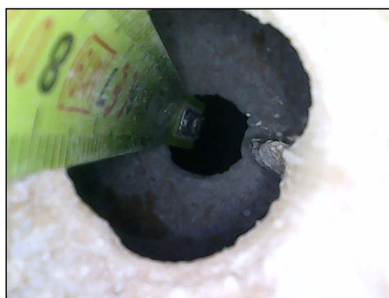
Foto 5 e 6 – Indagine endoscopica. A sinistra: il microforo con il cavo dell'apparecchio e la bandella metrata. A destra: immagine ripresa in foro.
