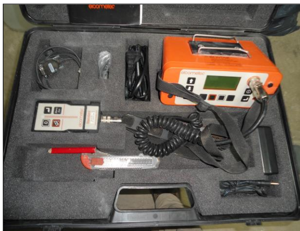
Foto n° 2 – Il pacometro Elcometer utilizzato per i rilievi.
