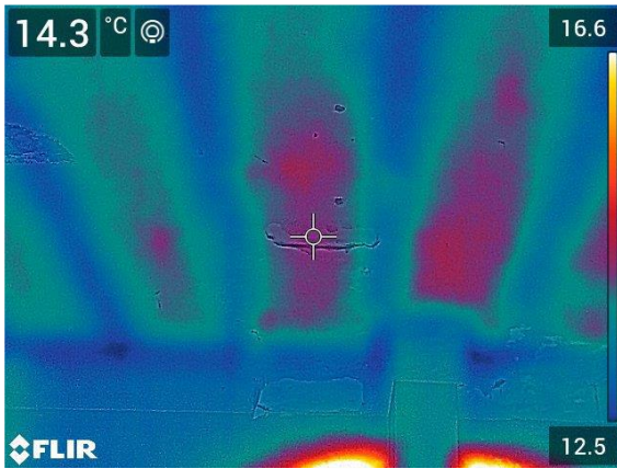
Figura 15: Indagine termografica del solaio del piano primo
