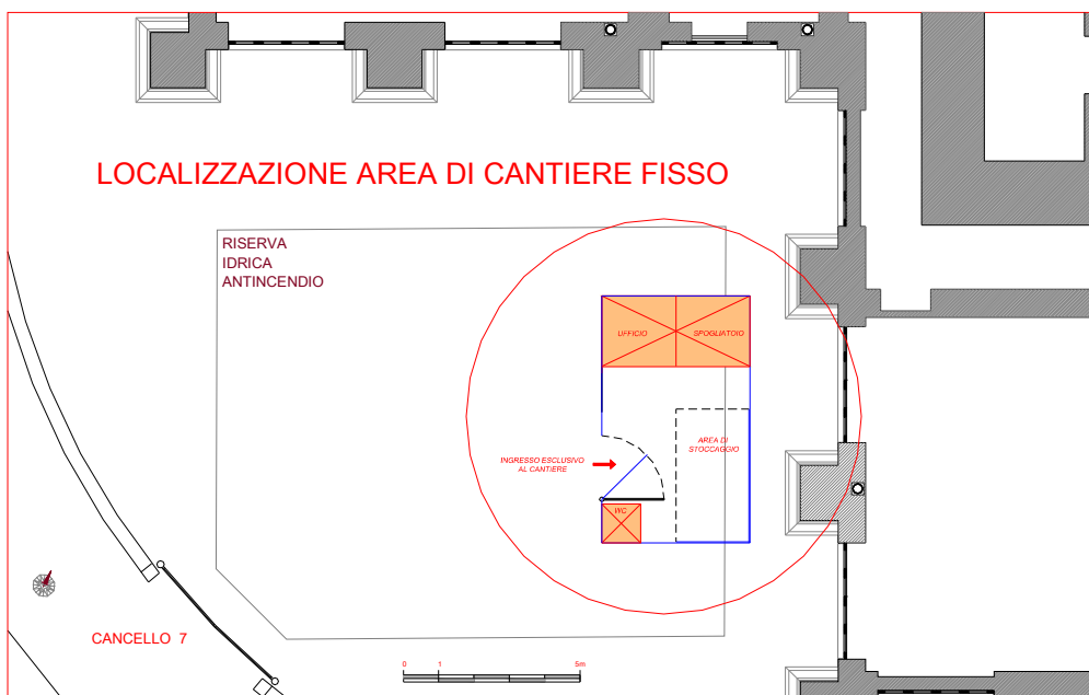
Individuazione dell'area del cantiere fisso all'interno del parterre del Teatro Massimo
