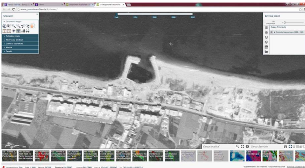
FOTO n. 8 - (da GEOPORTALE – Ministero dell'Ambiente) Situazione nel 1988 È evidente la linea di costa che ad EST coincide quasi con l'estremità del molo sottoflutto
