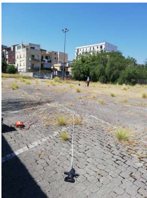
Foto 2 – Momenti di acquisizione sismica SS2 e MASW2
