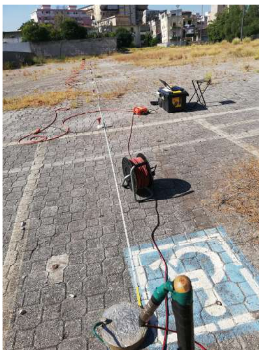
Foto 1 – Momenti di acquisizione sismica SS1 e MASW1
