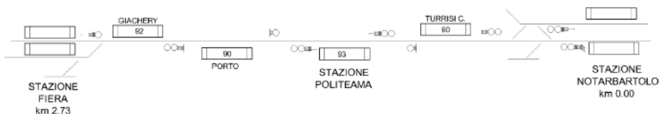
Figura 21 – Assetto ferroviario Stazione Politeama.
