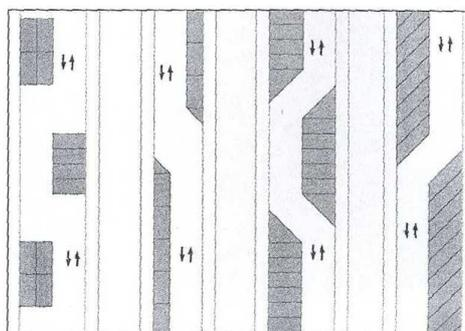
Fig. 35 - Esempi di chicane
