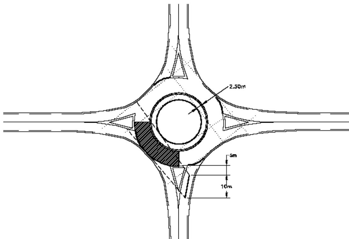
Fig. 23 - Triangoli di visibilità in incrocio a rotatoria
