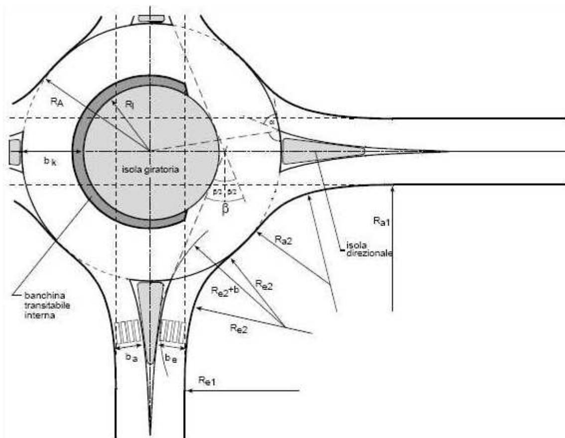
Fig. 22 - Elementi geometrici caratteristici per il dimensionamento di una rotatoria
