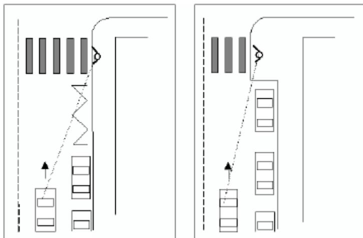
Fig. 36 - Esempi di disposizione della sosta in prossimità dell'intersezione
