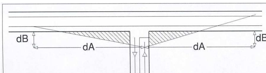
Fig. 18 - Triangoli di visibilità per intersezioni in cui sulla strada secondaria vige il segnale "Dare la precedenza" o "stop".
