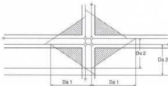
Fig. 17- Triangoli di visibilità per intersezioni con precedenza a destra
