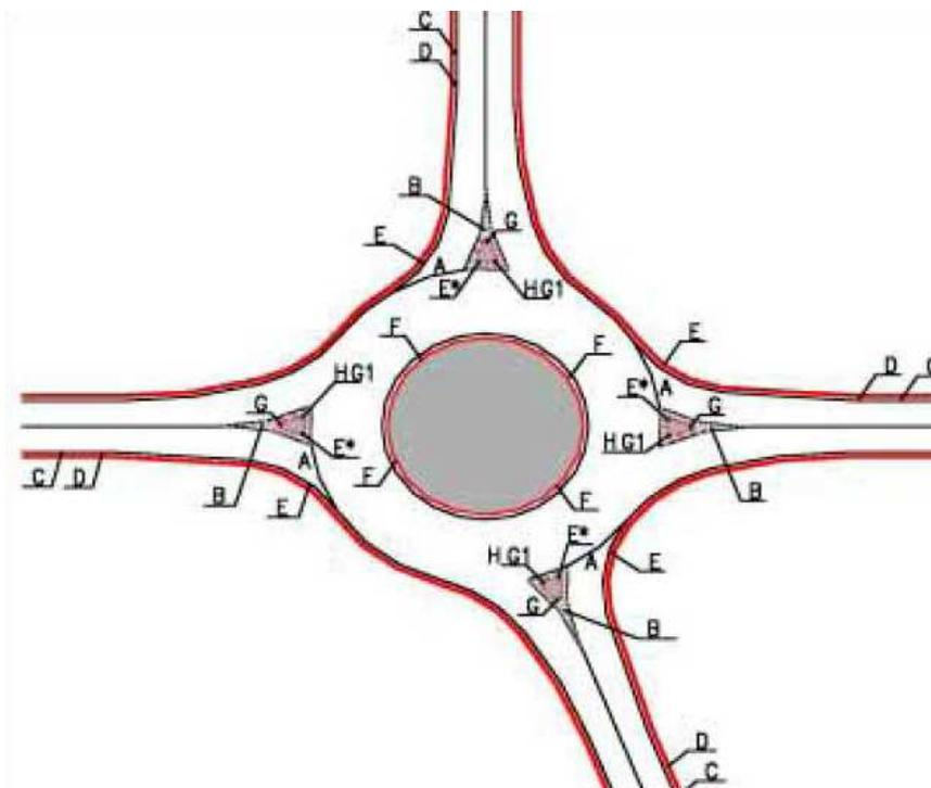
Fig. 24 - Posizionamento della segnaletica verticale e orizzontale nelle rotatorie
