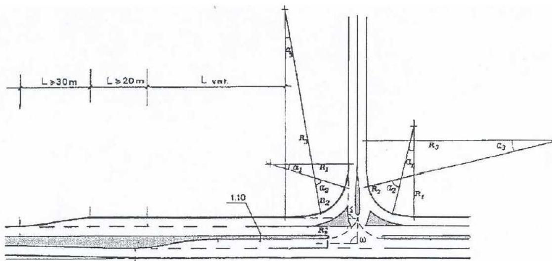
Fig. 19 - Parametri caratteristici per il tracciamento dei cigli delle intersezioni
