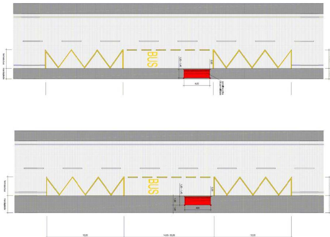
Fig. 32 - Fermata bus su strada senza sosta laterale
