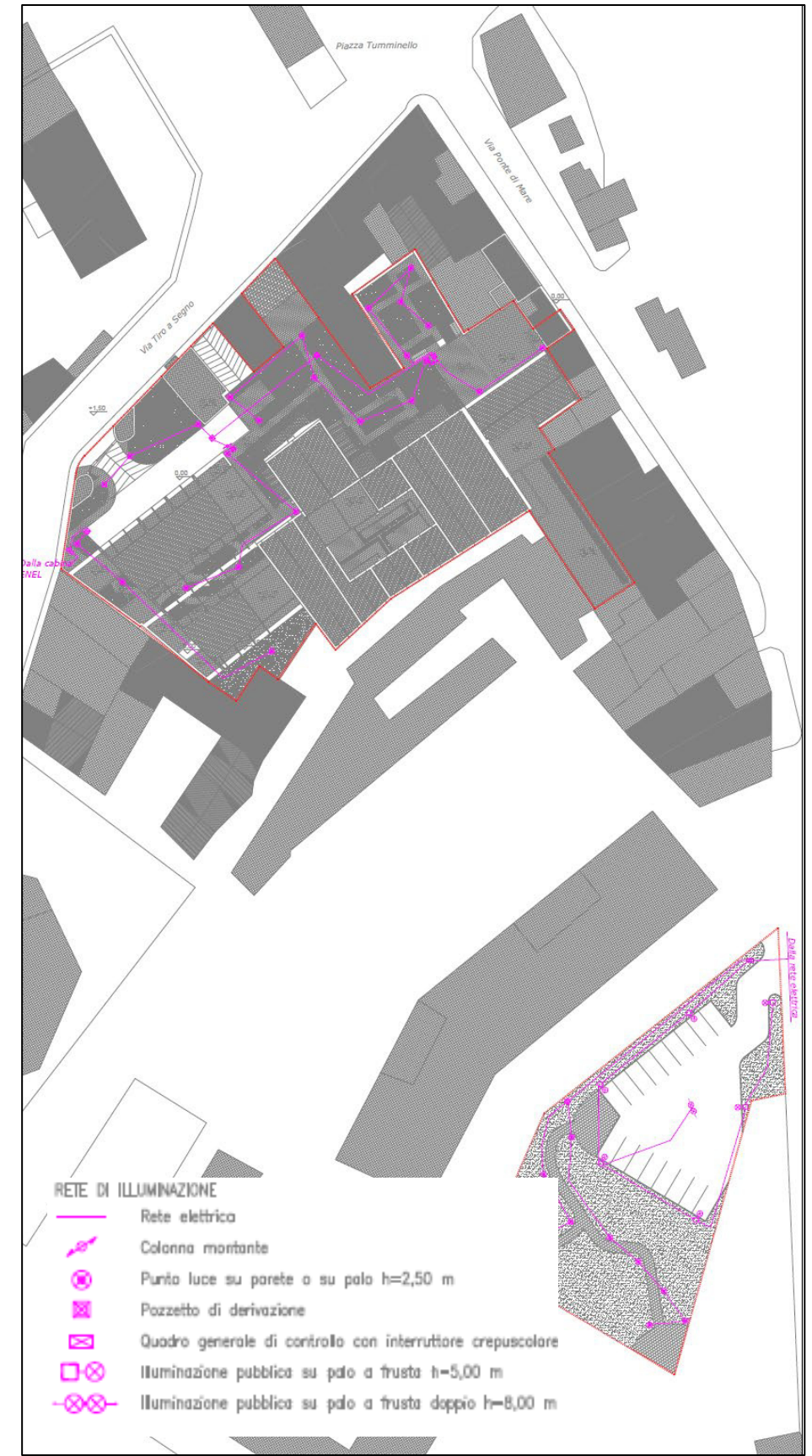
Fig. 21 - Planimetria generale con indicazione della rete di illuminazione (v. TAV. 20)
