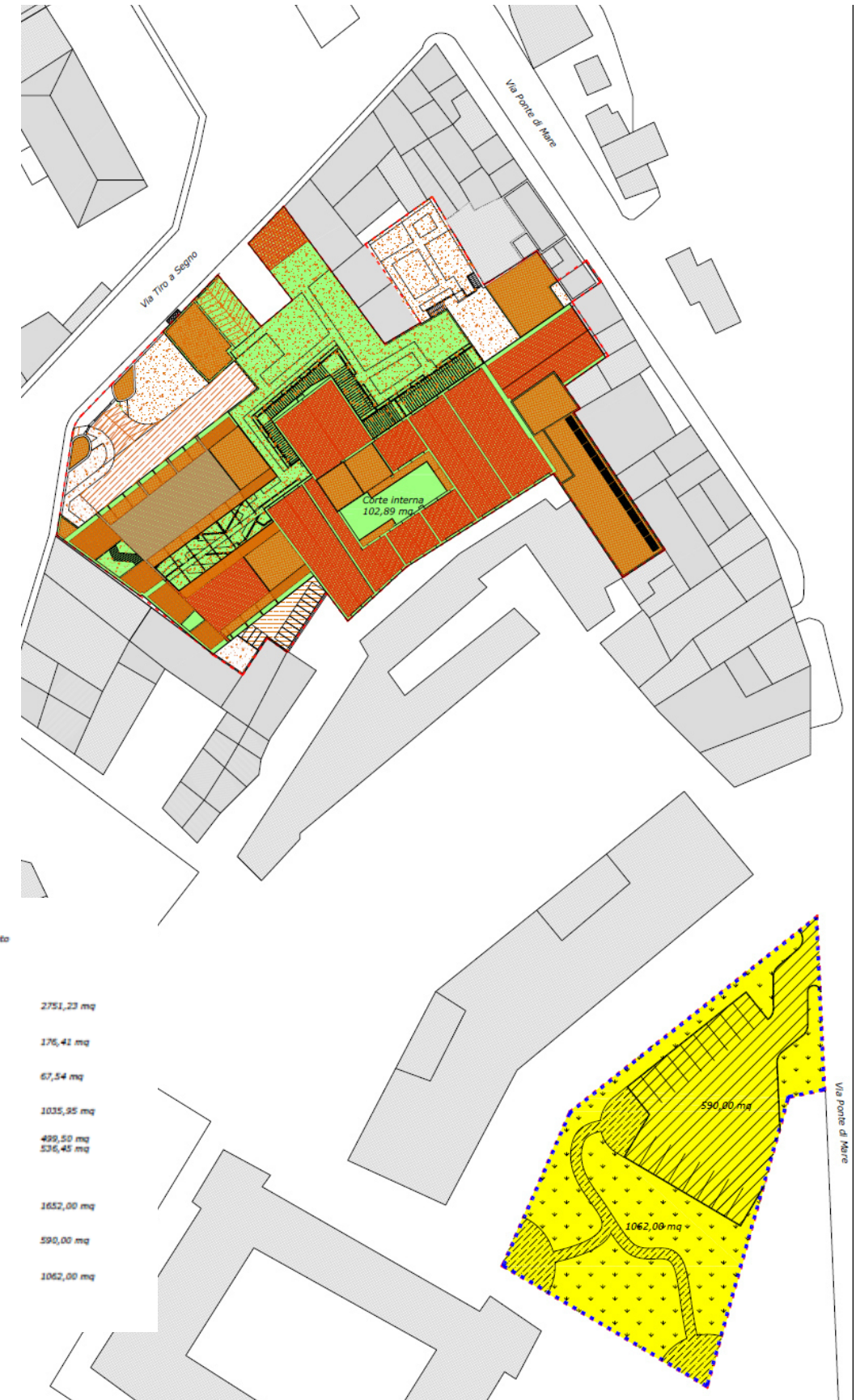
Fig. 12 - Stralcio della TAV.9 - Planimetria con indicazione delle destinazioni d'uso, calcolo delle superfici e standard urbanistici (scala originaria 1:200)
