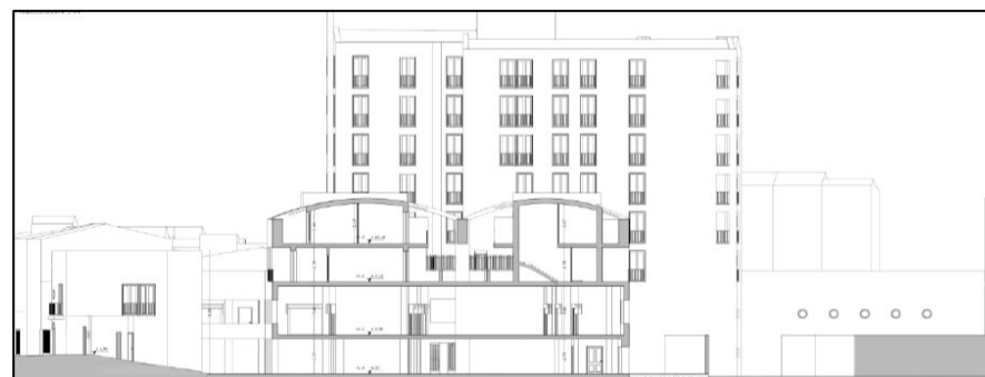
Prospetto-Sezione perpendicolare la Via Tiro a Segno
